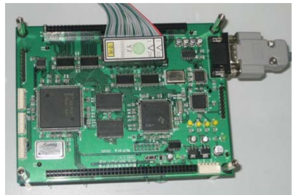
그림 2. 자체 제작한 UHF RFID 리더 디지털 파트.
