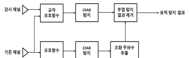
그림 1. PCL 수신기의 FDOA 축 부엽에 의한 탐지 결과 제거를 위한 PCL 설계도.
